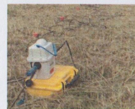
2. ábra: Terepi adatgyűjtő (bal oldal) és geofon (jobb oldal)
